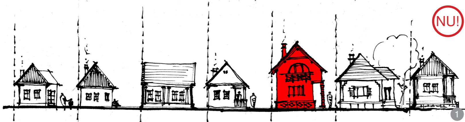
AȘA NU: Nerespectarea aliniamentului general la streășină și la coamă atrage după sine agresarea imaginii de ansamblu al desfășuratei stradale.
