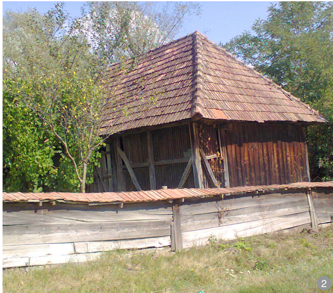
Împrejmuire specifică local din scânduri late din lemn dispuse orizontal
