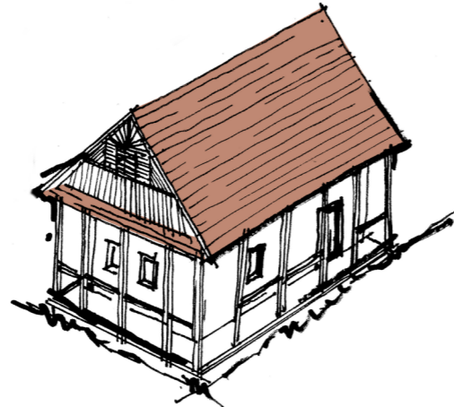
Locuință cu acoperiș în două ape cu pridvor din lemn pe două laturi, fronton din lemn decorat și aruncător
