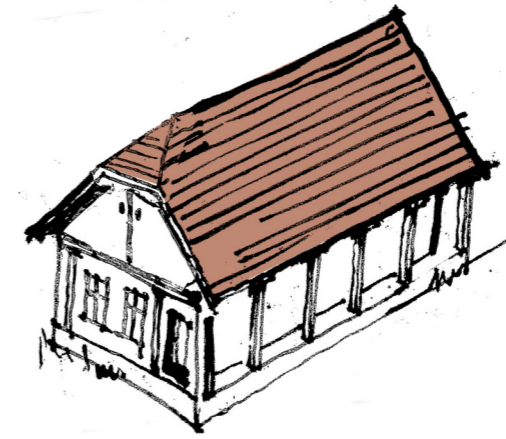
Locuință cu acoperiș în două ape cu fronton tencuit teșit și pridvor din lemn pe o latură
