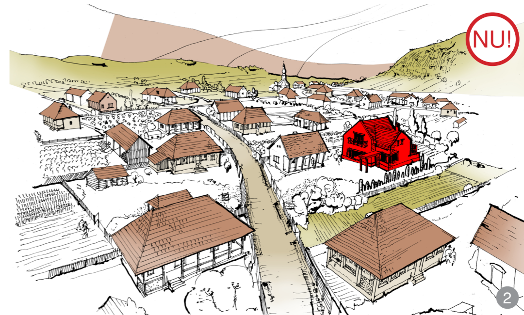
AȘA NU: Este interzisă demolarea șurilor tradiționale și înlocuirea lor cu construcții de gabarit prea mare care nu respectă specificul local. Recomandăm recondiționarea și folosirea șurilor existente.
