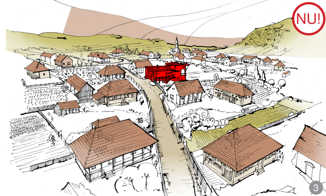
AȘA NU: Este interzisă construirea de clădiri cu acoperiș terasă și cu un limbaj arhitectural ce nu respectă specificul local rural și care seamănă mai degrabă cu vile urbane.
