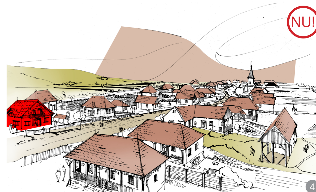
AȘA NU: Supradimensionarea clădirilor este interzisă, chiar dacă respectă regimul de înălțime și aliniamentul stradal. În cazul necesității realizării unei construcții de suprafață mare, se recomandă segmentarea gabaritului în volume ierarhizate adecvat.
