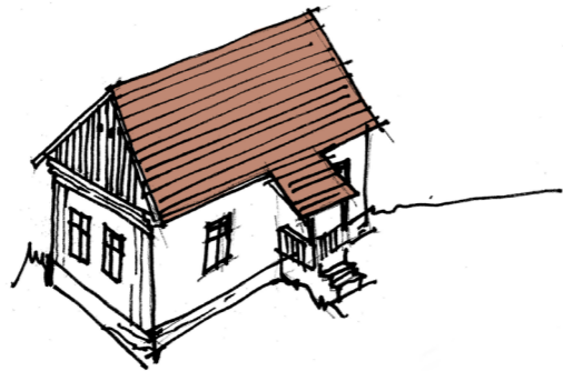
Locuință cu acoperiș în două ape cu frigurie simplă fără fronton
